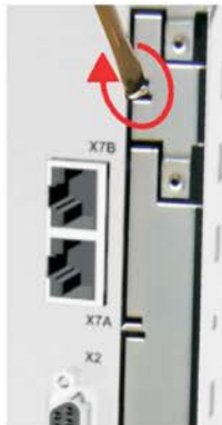
4 - Break the top rib
