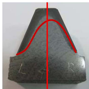
Špatné indukční kalení a/nebo broušení zubů
