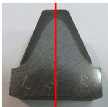
Správné indukční kalení a broušení zubů
